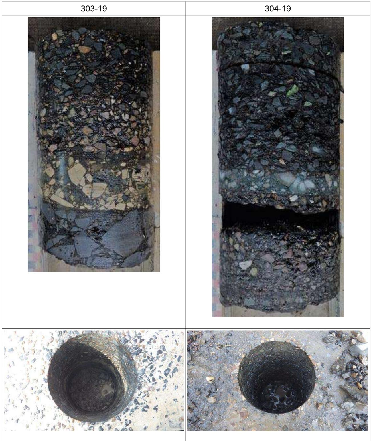
Les carottages ont révélé la présence d'une structure différente sur les deux zones de dégradations. Les deux carottes montrent la présence d'une structure bitumineuse de plus de 25 cm. Au niveau de la zone 2, la carotte montre un collage fragile de la couche de roulement et une couche de liaison « médiocre ».
