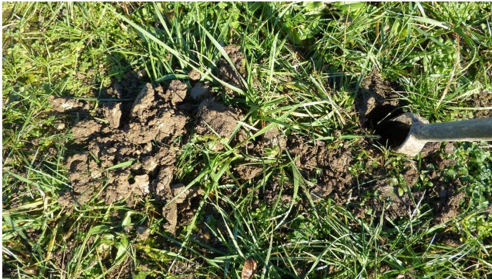
Figure 48 : Sondage de sol S1, caractéristique d'un sol limons argileux sur calcaire de classe la selon la classification GEPPA – source : IAD.
