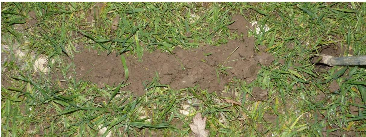
Figure 49 : Sondage de sol S11, caractéristique d'un sol limons argileux sur calcaire de classe la selon la classification GEPPA – source : IAD.
