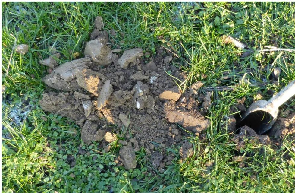
Figure 58 : Sondage de sol S8, caractéristique d'un sol brun limoneux argilo calcaire aéré et caillouteux de classe la selon la classification GEPPA et similaire au sondage S7 – source : IAD.
