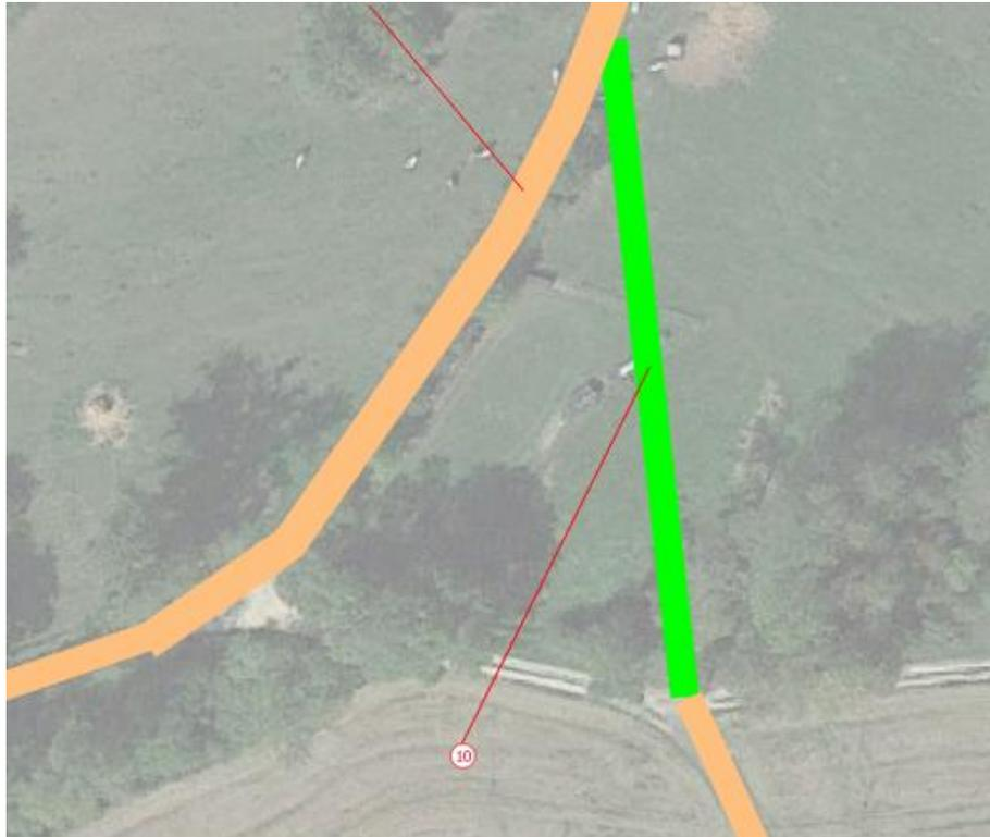
Figure 38 : Virage en épingle et création de chemin n° 10 pour améliorer la circulation - Source : BD ortho 2018, Géomètre.
