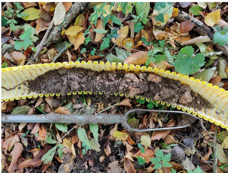
Figure 57 : Sondage de sol S13, caractéristique d'un sol brun limoneux argilo calcaire, de la classe la – source : IAD.
